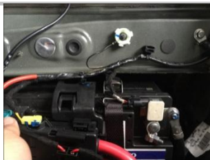
3.14 接负极 (解码器负极): 在左侧装饰板内找到螺丝, 把我们的负极线搭上, 松动螺母不用拆下, 卡紧后再还原拧紧螺母;
