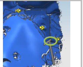
2.3 螺母块的安装位置如图所示，画圈出，两个螺母块穿过洞口。
