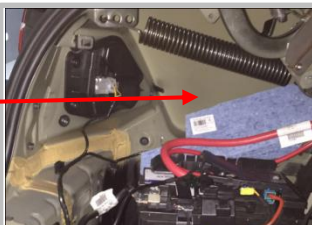
4.8 安装蜂鸣器 :并把蜂鸣器装在左侧装饰板内空旷处;( ECU 附近)
