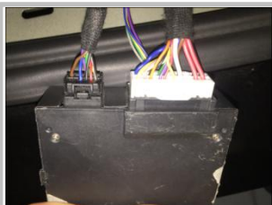
4.1 连接 ECU: 把所有各部位线束插头连接好, 最后把主线束插头对应安装到 ECU 上, 先大后小的顺序接上,
