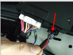
3.12 解码器控制信号线:ECU开关控制线[黑]接解码器[橙色]控制信号线
