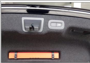
4.4 安装开关按钮: 拆下原车开关
