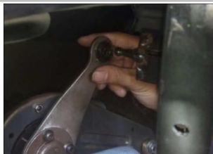
用工具配合把螺栓拧紧后把开口销安装即可
