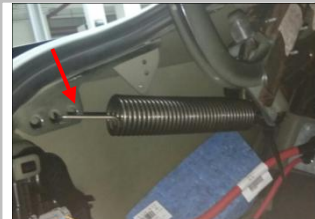
2.19 把两边气弹簧调到箭头位置此孔内(减少拉簧力量的孔),调整弹簧开关门速度
