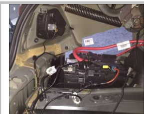
3.10 解码器线束接在尾箱左侧及电瓶处
