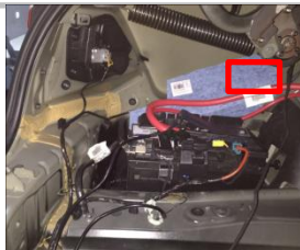
4.2 ECU 放置位置: 使用魔术贴固定在左侧钣金, 注意线束朝下防止进水
