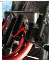
3.15 撑杆正极 (解码器正极): 连接此处原车电瓶正极, 拧紧
