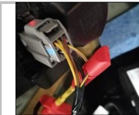
3.11 解码器控制信号线:在尾箱左侧内找到原车此线束连接器,原车[黄紫]信号控制线接解码器[橙色],转向灯找线方法:打开双闪,用试电笔看,闪烁频率和转向灯相同
