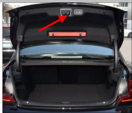
3.1 拆卸上门锁盖板,然后把线束如虚线穿到上门锁盖板;
