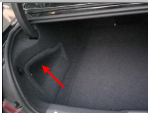
2.1 把左边内侧装饰件拆下，并妥善保管好，后续还原安装，注意防止尾门掉下
