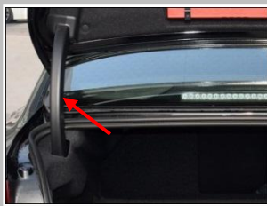
3.2 拆卸塑料扣,原车摇臂上的塑料件拆下,
