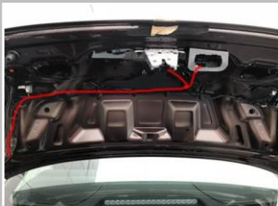
3.4 开关线、信号线如图示意延伸在上尾门
