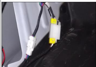
3.16 线束连接好后, 把各位置的插头确保对插完成
