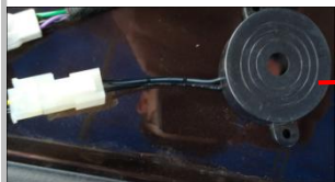
4.7 安装蜂鸣器 :与线束接头对接
